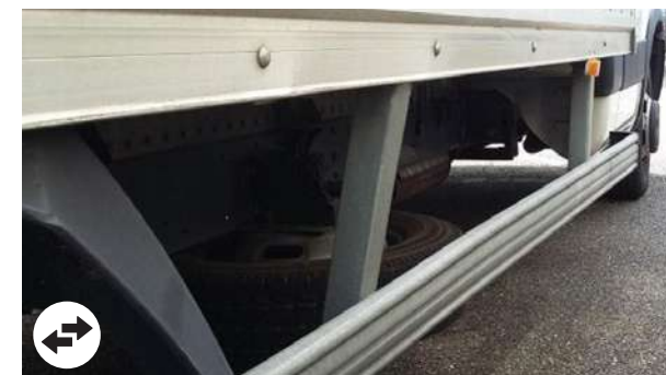
Barre di protezione: deformazione dalla riparazione economicamente conveniente
