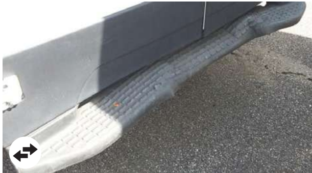
Pedane posteriori: deformazioni > di 3 cm di lunghezza.
