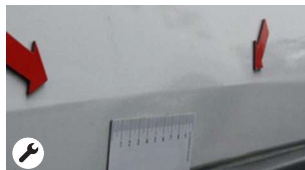
Difetto: pannello deformato in seguito a riparazione
