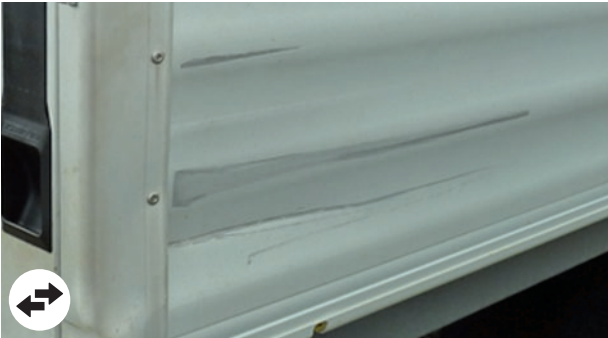
Deformazioni nelle sponde se ≥ di 10 cm, chiusura impossibile o con perdita di materiale (es. sabbia)
