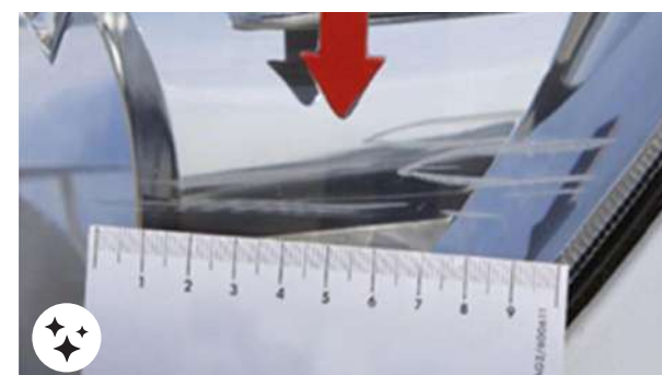
Graffio profondo (con rimozione di materiale), al di fuori della superficie di illuminazione e relative parti sigillate
