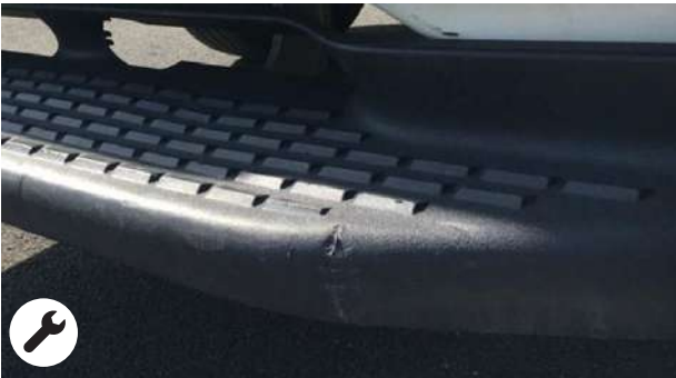
Pedane posteriori: deformazioni dalla riparazione economicamente conveniente
