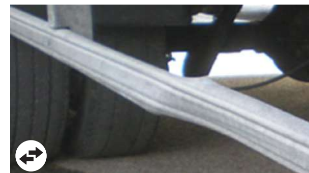
Barre di protezione: deformazione dalla riparazione antieconomica
