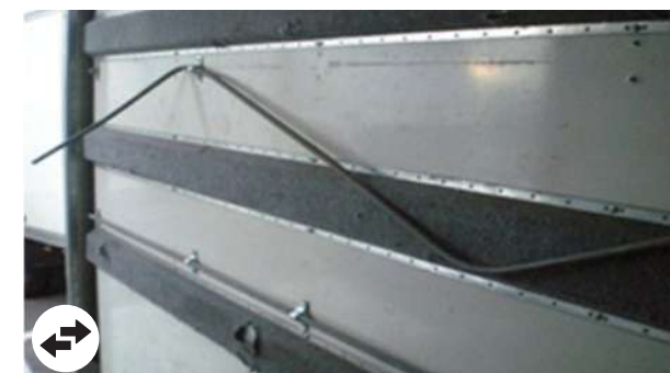
Tessuti e aste: Aste, fermagli, tessuti mancanti o con deformazioni dalla riparazione antieconomica
