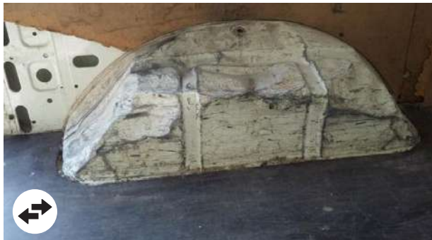
Deformazioni interne: Perforazioni, tagli, deformazioni dalla riparazione antieconomica. Depositi di materiale snaturanti e non correggibili (polvere, vernice, ecc.) (Passaruota non recuperabile con tempo di riparazione < 3h)
