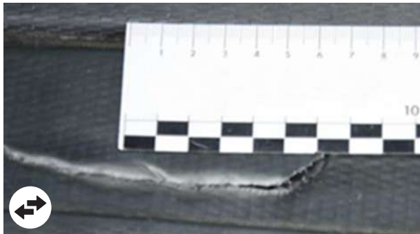
Perforazione dei profilati in plastica rigida. Riparazione dei profilati in plastica rigida 1 ora (forfait) se esteticamente accettabile e riparabile
