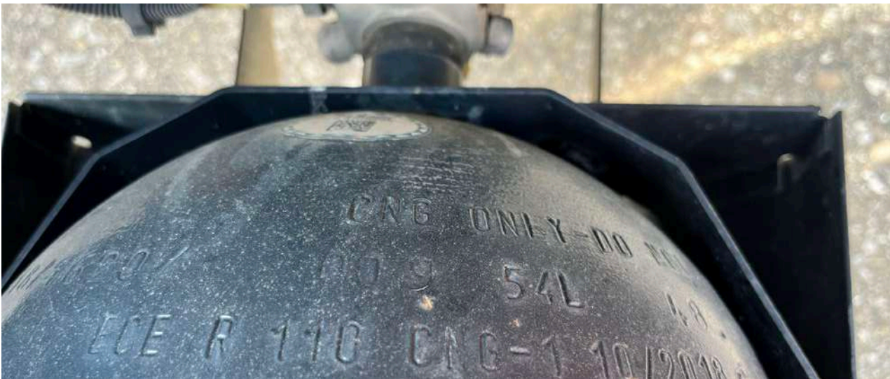
Presenza di un certificato di validità aggiornato leggibile per bombola CNG.
