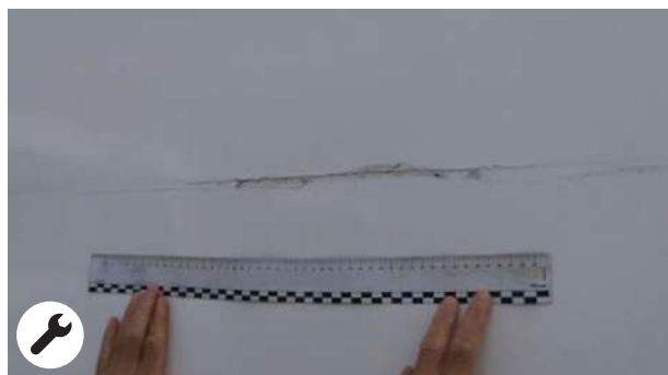
Fiancate: Graffio con rimozione di materiale \geq 10 cm dalla riparazione economicamente conveniente. Possibilità di verniciare mezzo pannello
