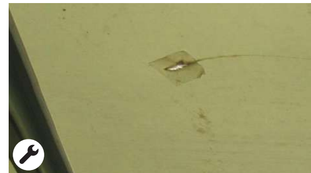
Padiglione: Perforato o strappato e dalla riparazione economicamente conveniente
