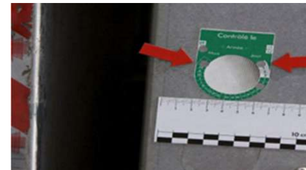
Sponda caricatrice: date di controllo scadute
