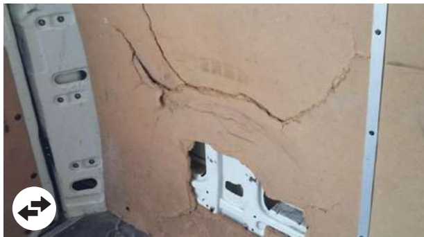
Protezioni interne in legno: Urti > di 2 cm, pannello strappato, pannello mancante (esclusi i pannelli superiori delle porte)
