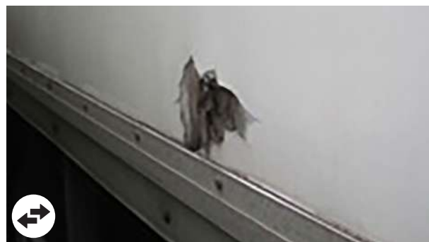
Fiancate in legno: Supporti in legno danneggiati \geq 20 cm
