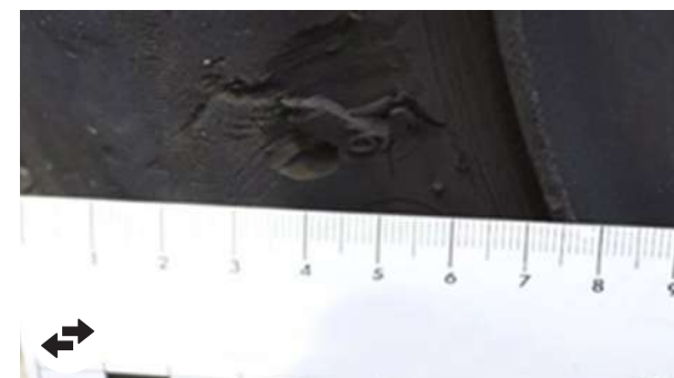
Pneumatici: Tacca > 3 mm di profondità, rimozione
