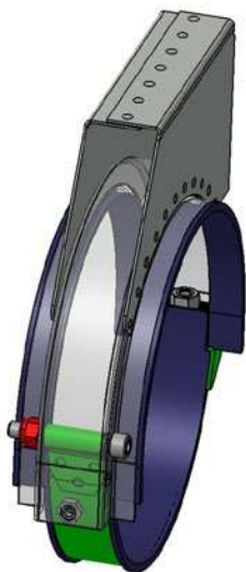
Fissaggio della fascia di supporto del serbatoio: controllare lo stato dei componenti (ossidazione, sovraccarico, ecc.)
