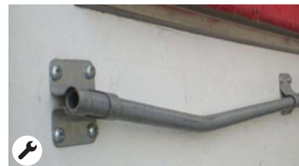
Tessuti e aste: Aste e tessuti con deformazioni dalla riparazione economicamente vantaggiosa
