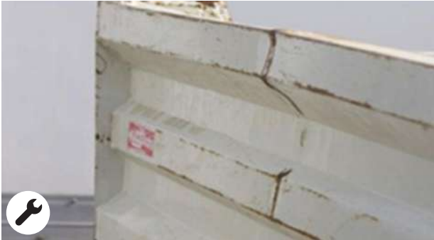
Deformazioni nelle sponde con tempi di riparazione > 1 h e se < di 10 cm
