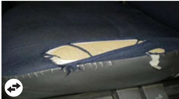
Bruciatura > 3 mm, perforazione o strappo nella copertura, senza deterioramento della schiuma
