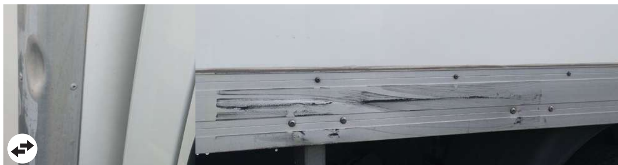
Profili laterali nel sottoscocca: deformazioni \geq 10 cm
