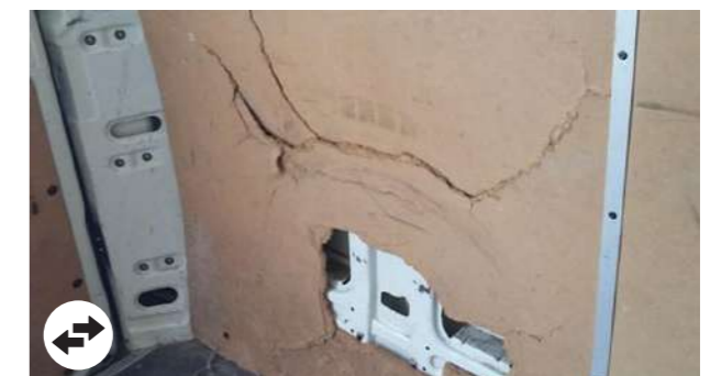
Protezioni interne in legno: Urti > di 2 cm, pannello strappato, pannello mancante (esclusi i pannelli superiori delle porte)
