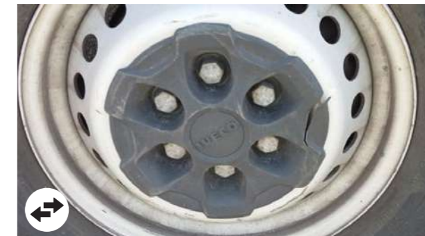
Copri ruota: deformato, rotto, con materiale mancante o rimosso
