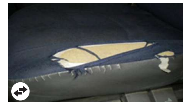
Brucciatura > 3 mm, perforazione o strappo nella copertura, senza deterioramento della schiuma
