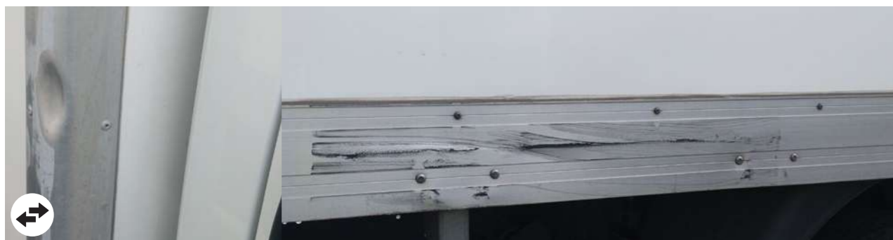
Profili laterali nel sottoscocca: deformazioni \geq 10 cm
