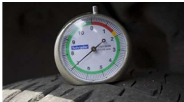
Pneumatici: Base della scanalatura \geq 5 mm di profondità (CONFORME)
