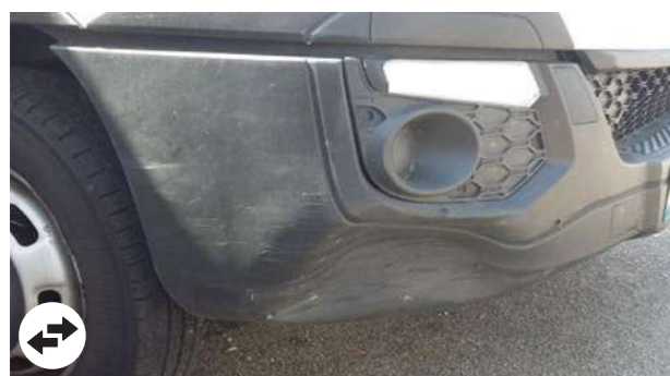
Rottura, rimozione di materiale o deformazione dalla riparazione infattibile o antieconomica
