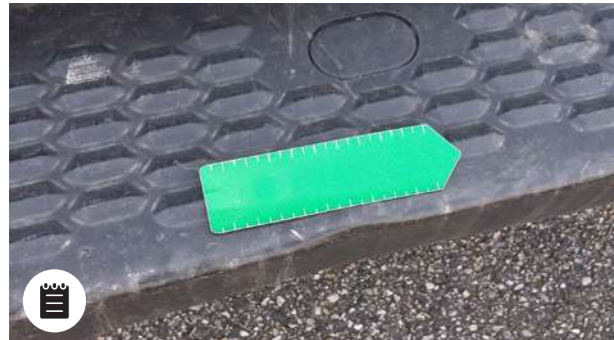
se \leq 3 cm lunghezza singola o cumulativi (esempio se sono 3 deformazioni da 1 cm)
