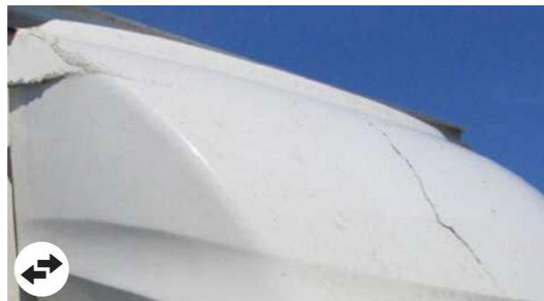
Carenatura del tetto e deflettore: Incrinatura, componente mancante
