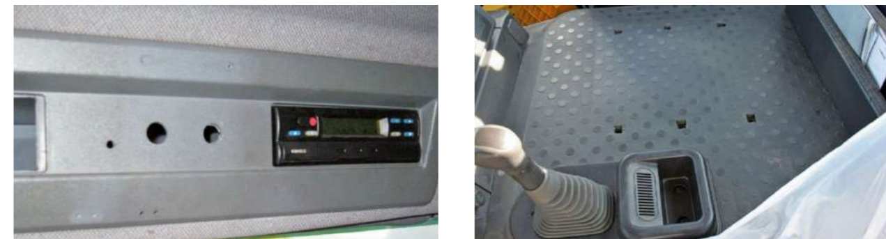
Componenti di comando, componenti del sedile o dei rivestimenti mancanti, rotti o forati
