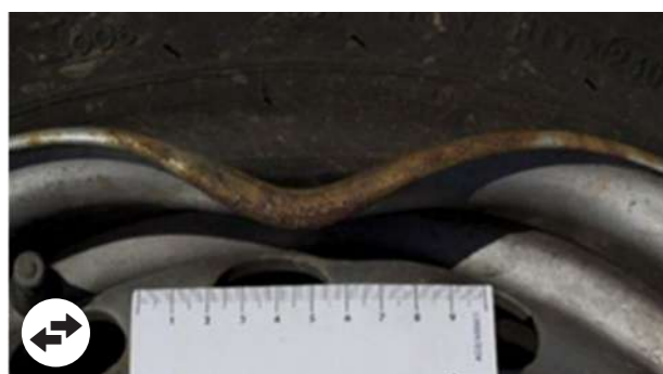
Rivestimento cerchio deformato, cerchio non conforme. Valutazione di eventuale controllo dimensionale del veicolo per verifica dello stato di sicurezza
