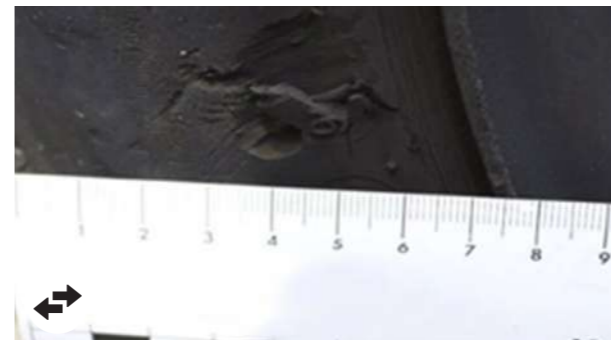
Pneumatici: Tacca > 3 mm di profondità, rimozione
