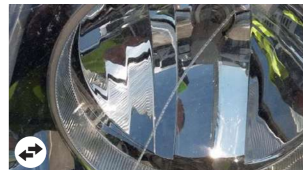
Graffio nella superficie di illuminazione, incrinatura, condensa, rottura o fermaglio rotto
