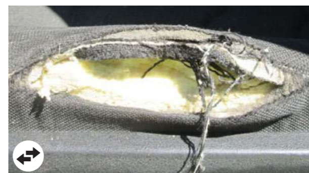
Schiuma mancante o telaio rotto
