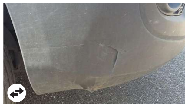
Rottura, rimozione di materiale o deformazione dalla riparazione infattibile o antieconomica
