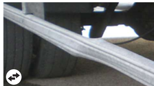
Barre di protezione: deformazione dalla riparazione antieconomica
