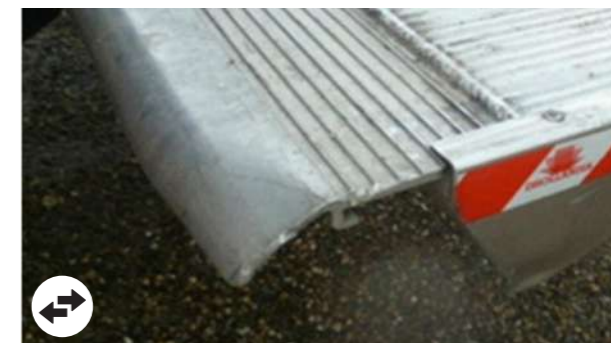
Sponda caricatrice: deformazioni della piattaforma dalla riparazione economicamente conveniente
