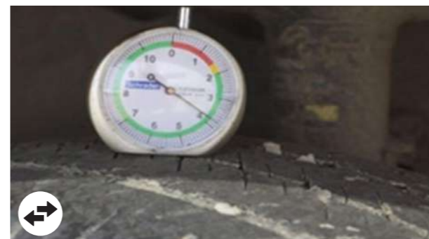
Pneumatici: Base della scanalatura < 5 mm di profondità
