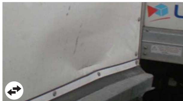
Porte laterali e posteriori: Deformazione rilevante: Tempo di riparazione > 1 h dalla riparazione economicamente conveniente, chiusura non a tenuta
