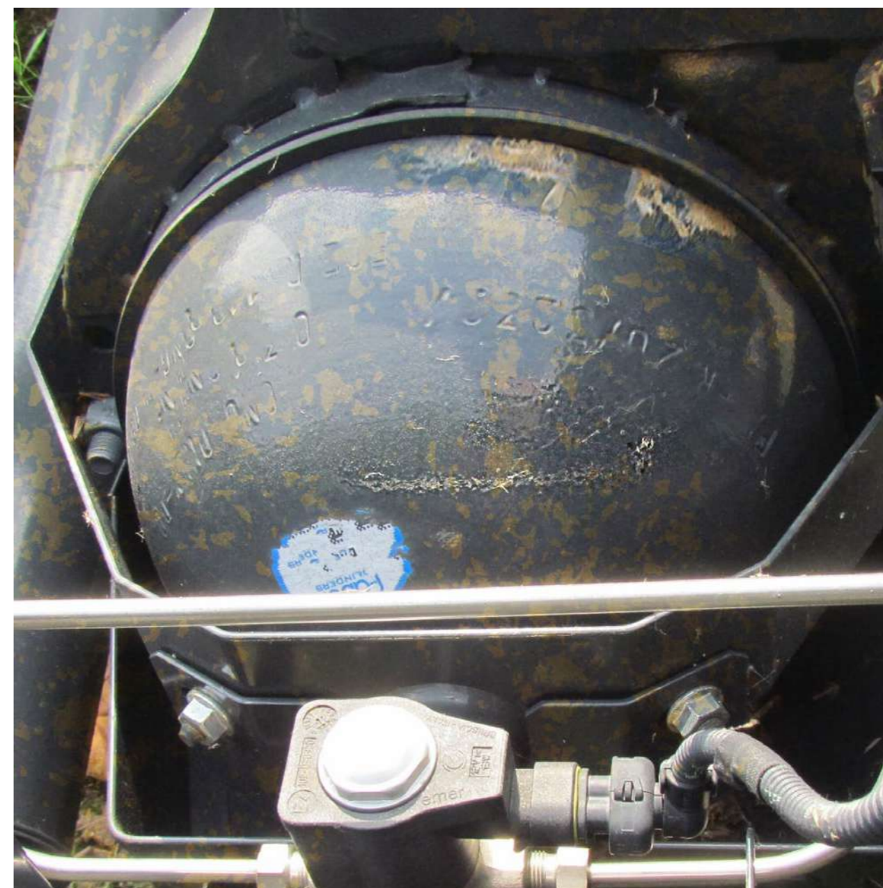
Marcatura di identificazione della bombola di CNG originale assente o illeggibile
