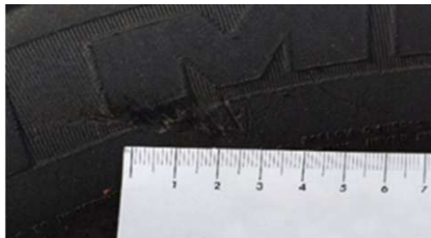
Pneumatici: Tacca \leq 3 mm di profondità (CONFORME)
