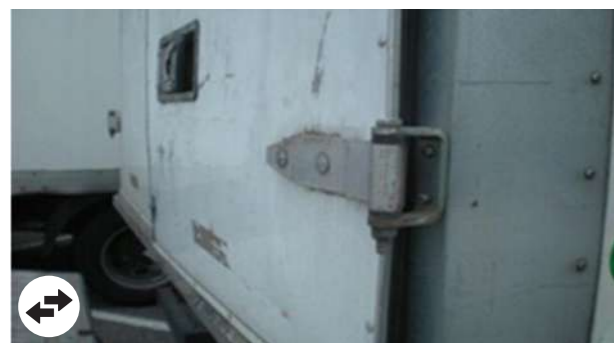
Porte laterali e posteriori: Porte piegate in corrispondenza dei perni delle cerniere, rotte, perforate o dalla riparazione antieconomica
