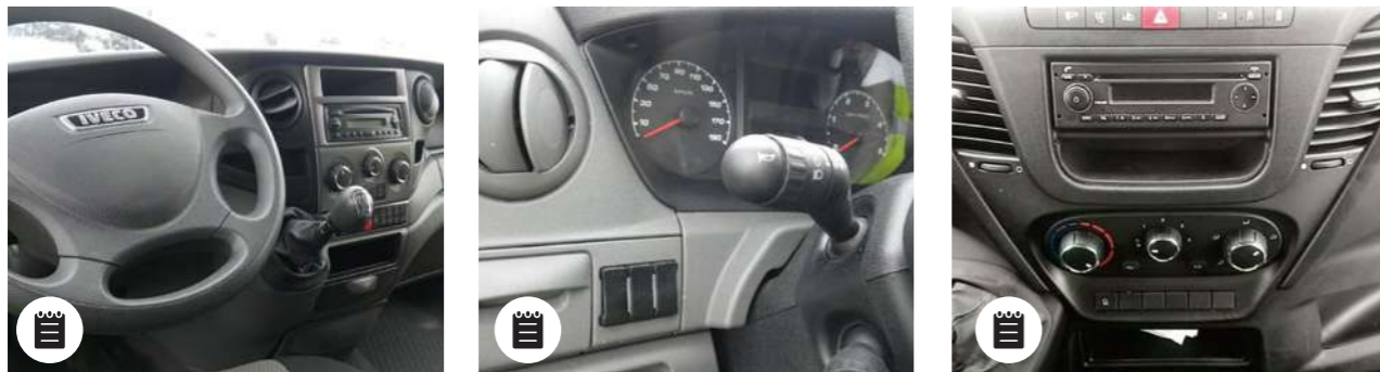
Tracce di usura sul quadro portastrumenti, sull'instrument cluster e sul volante
