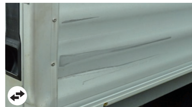
Deformazioni nelle sponde se \geq di 10 cm, chiusura impossibile o con perdita di materiale (es. sabbia)
