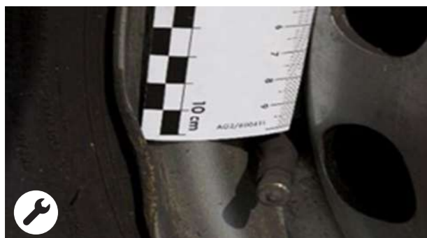
Su cerchio in acciaio: Leggera deformazione del bordo di contatto
