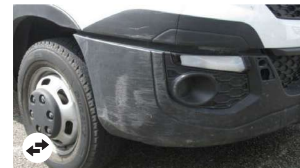
Rimozione di materiale o deformazione dalla riparazione fattibile se > \text{ o } = 10 \text{ cm}
