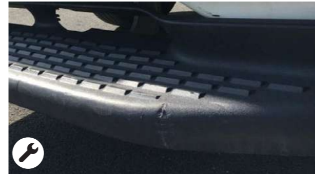
Pedane posteriori: deformazioni dalla riparazione economicamente conveniente
